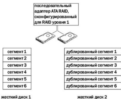
В случае неисправности одного диска операции чтения и записи производятся на другом диске. Замененный диск может затем быть восстановлен с использованием данных на исправном диске.
